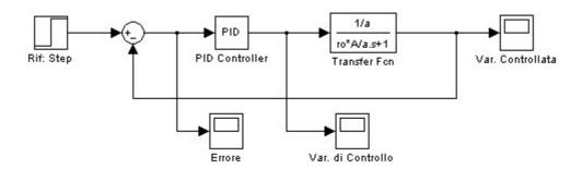
In particolare il seguente blocco PID già implementato in Simulink è possibile trovarlo nel Simulink Library Browser seguendo il percorso Simulink Extras\Additional Linear\PID Controller.
