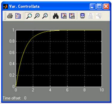
Grazie, a questo tipo di regolazione le specifiche sono ancora una volta soddisfatte con il vantaggio che ora la variabile di controllo assume valori più contenuti.
