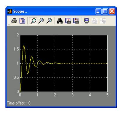
Tale andamento mostra quanto sia facile con questo tipo di regolazione ottenere, nel tentativo di migliorare la risposta del sistema, un andamento oscillante del sistema: la FdT in Anello Chiuso è quindi una funzione del Secondo Ordine a Poli Complessi Coniugati.
